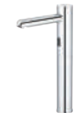
A717 18,300 電源 : 110V/220V * 220V 訂貨生產 A717DC (全配、DC) 19,800 單冷水加長自動感應龍頭 電源 : 電池 1.5Vx4 顆 適用水壓 1 ~ 6kgf/cm 2 H : 34 H1 : 29.2 L : 9.4cm
