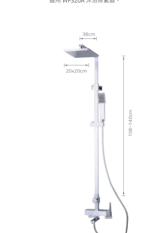
S478C LED 淋浴蓮蓬頭 27,500 特色： 1. 住屋水路系統無須更改，能立即安裝與使用。 2. 頂噴、手持花灑內建 LED 顯示功能，隨水溫變化藍、綠、紅顏色，藍光為冷水，綠光為溫水，紅光為熱水。 3. 適用水壓：1.5 ~ 5kgf/ cm 2 適用 WF320A 沐浴除氯器。
