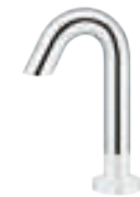
A728 17,000 A728AC 16,000 A728DC 16,000 自動感應龍頭 H : 20.4 H1 : 14 L : 10cm 水壓範圍 : 1.5~5kgf/cm 2 • 電源選項 1. 水力發電 (免配電) 2. AC式 (110V/220V 共用) 3. DC 式 (電池 1.5Vx4 顆) 台灣精品 2014
